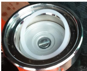
Buttonmachine 44mm: controleer of de plastic ring in de rechterhelft zit!
