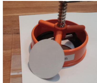
Buttonmachine 55mm: controleer of de metalen/plastic ring in de rechterhelft zit!
