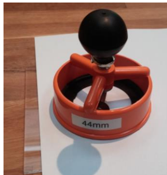
Buttonmachine 44mm: controleer of de plastic ring in de rechterhelft zit!
