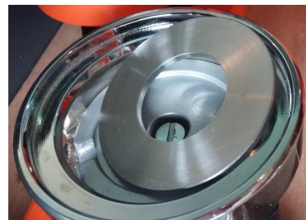
Buttonmachine 55mm: controleer of de metalen/plastic ring in de rechterhelft zit!
